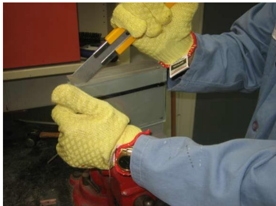
Зафиксируйте стекло, чтобы легко срезать силикон
