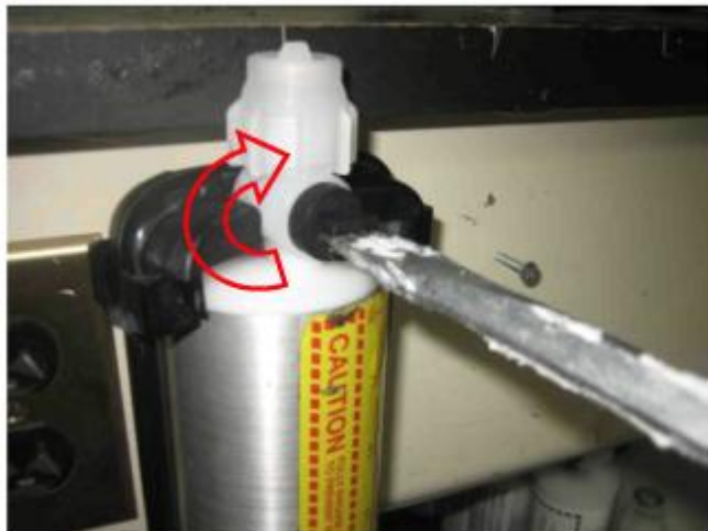
Этап 5 – с помощью отвертки поверните шаровой клапан на 90 градусов в положение «открыто»
