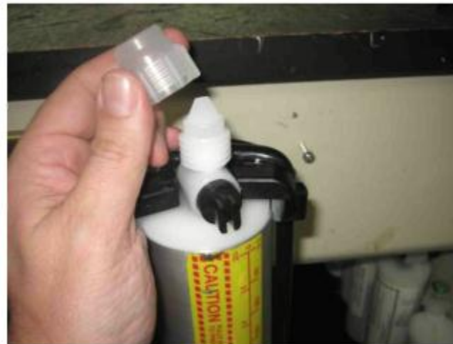
Этап 6 – снимите стопорную гайку
