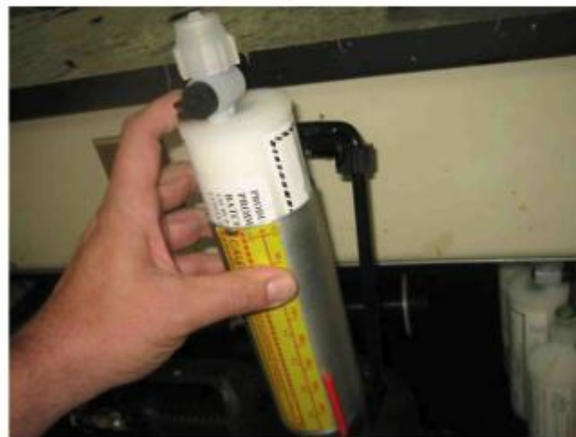
Этап 2 – вдавите КТДЖ до упора в цилиндр пистолета
