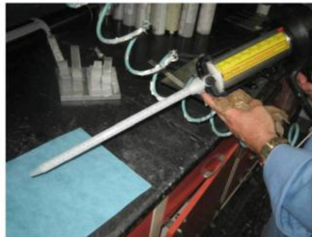
Этап 12 – нажмите на спусковой механизм, чтобы начать распределение
