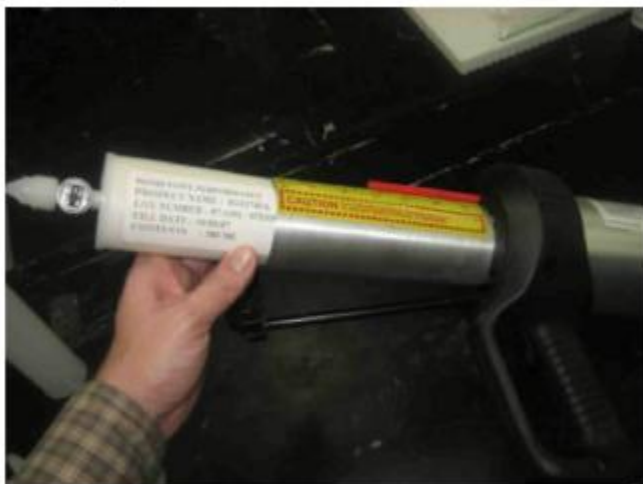
Этап 1 – вставьте картридж (КТДЖ) из 2 частей в пистолет Supermix
