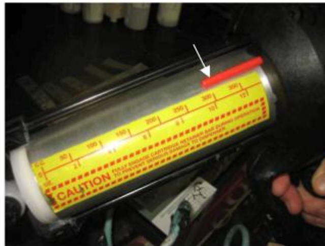
Оранжевый индикатор должен быть около отметки 300 мл перед использованием материала
