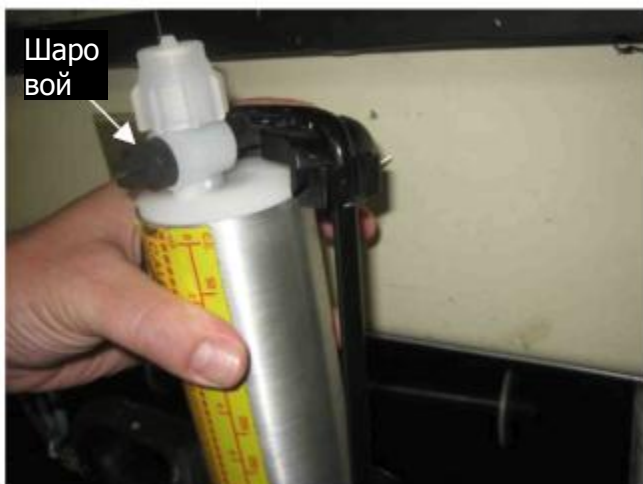
Этап 3 – выровняйте шаровой клапан с фиксирующим кронштейном
