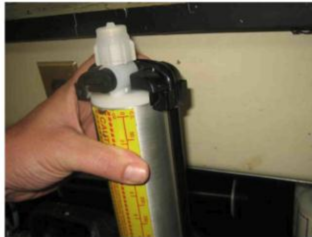
Этап 4 – защелкните фиксирующий кронштейн
